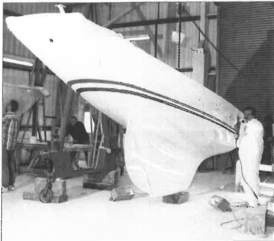
Au chantier Peticrows, on met la dernière main aux finitions d'un Peticrows 2000, un modèle en fibre de verre qui se singularise par son lest intégré dans le moulage de la coque.
