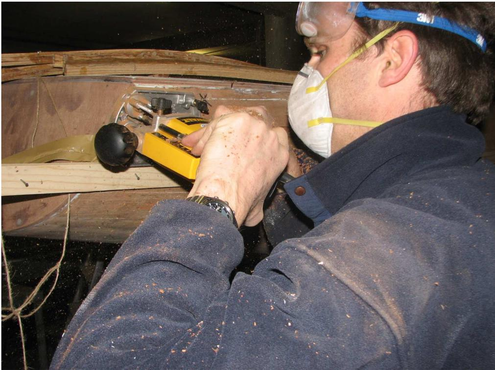
*Le final : La cale d'épaisseur évite à la lame de creuser avec trop de biais pour la réalisation d'un flipot correct.*
