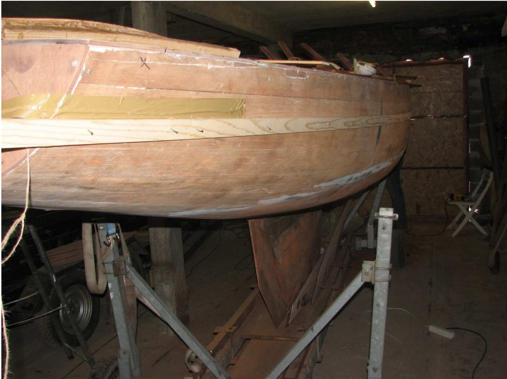
*Le guide en place et la cale d'épaisseur sur laquelle va s'appuyer la défonceuse dans l'arrondi du tableau arrière*
