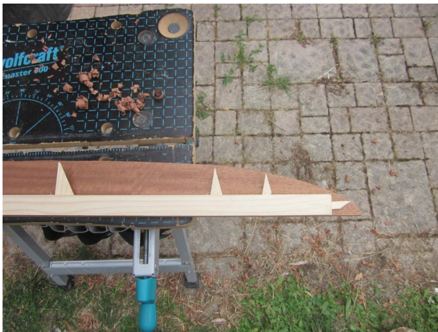
Comparaison entre le bordé approché à la scie à ruban et le gabarit donnant les formes finales
