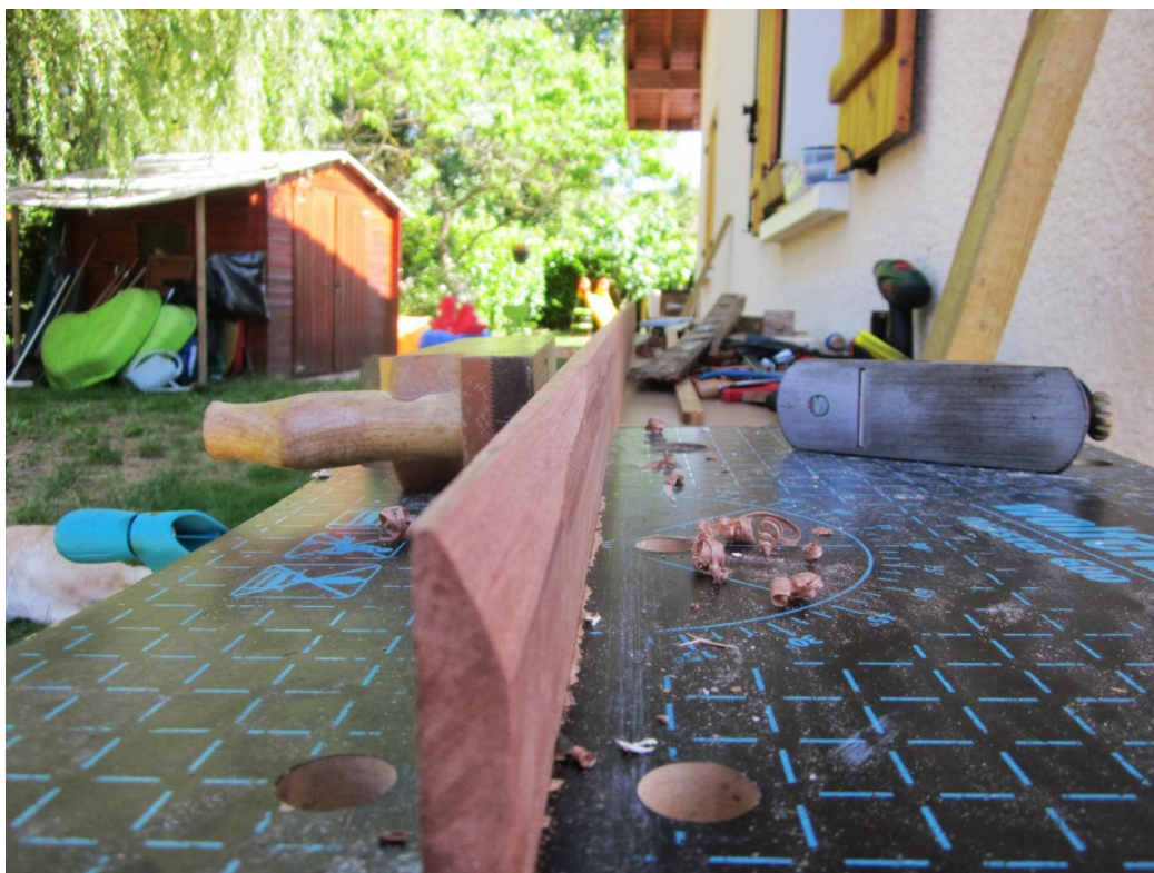
Découpe du côté rectiligne du bordé
