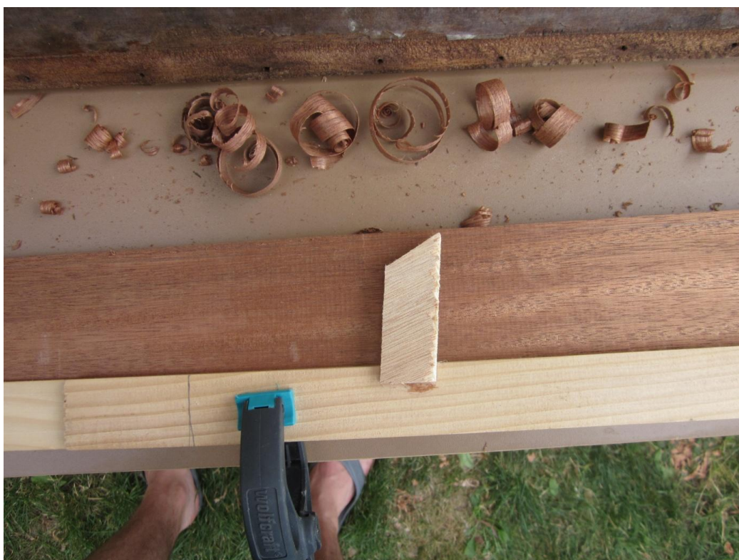
Utilisation du gabarit pour les parties courbes
