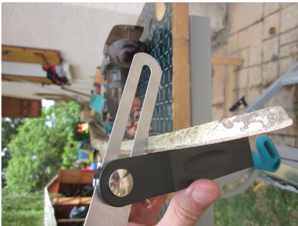
Prise de mesure pour rabotage de l'angle au niveau de la quille
