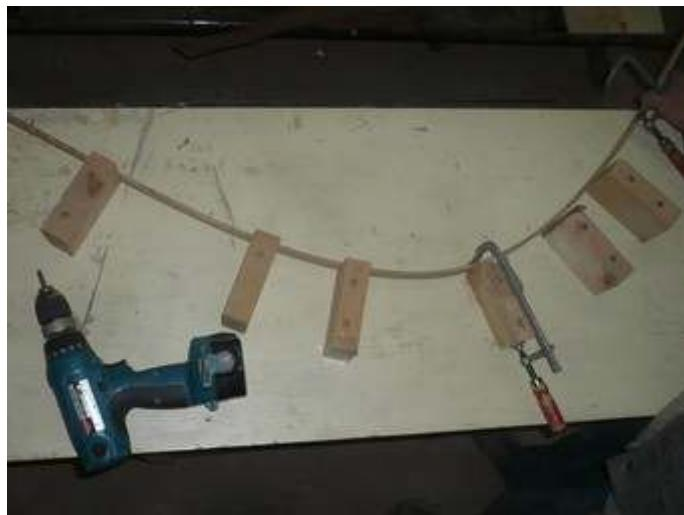
Les membrures du Moucheron ont une section de 15 mm (épaisseur) X 24 mm (largeur), ce qui nous donne les éléments suivants:
