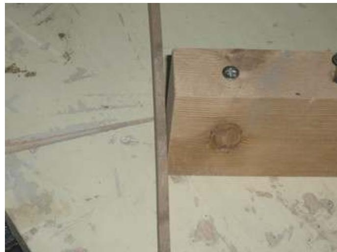
Vu? Si la cale ne suit pas parfaitement la courbe, on se trouve avec un angle en "point dur", donc un défaut d'alignement, et peut-être de la casse au serrage!
